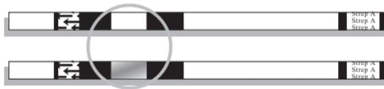
Se non appare nessuna linea di controllo di colore rosso o se il colore dello sfondo rende impossibile la lettura della linea di controllo di colore rosso, allora il risultato non è valido. In tal caso ripetere il test su una nuova striscia di test.
